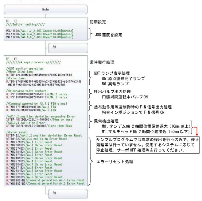
(2) No.1 Motion control:モーション制御 ノーマルタスク [自動起動] GOT からの起動により各モーション制御用のタスクを起動します。
