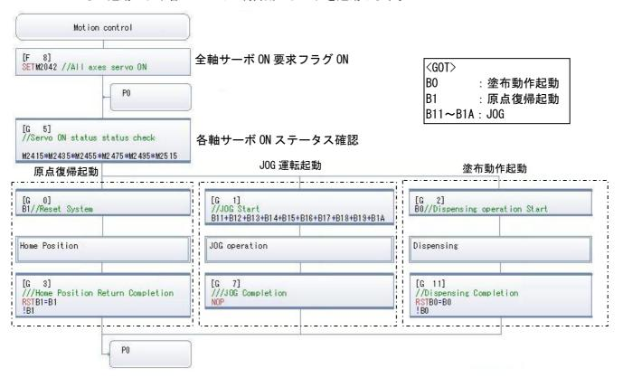
(3) No. 2 Origin setting: 原点復帰 ノーマルタスク 各軸の原点復帰サーボプログラムを実行します。
